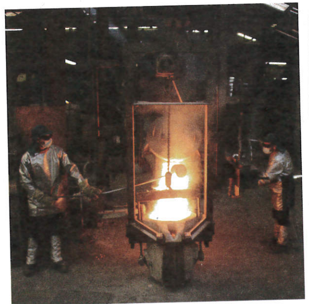
Un four de fonte en fonctionnement à 1 450 degrés.
